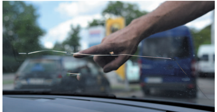
Foto: Axax Zu groß und im Sichtbereich – diese Scheibe muss erneuert werden.
