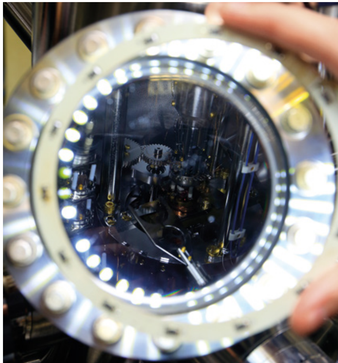
Blick auf ein Rasterkraftmikroskop in einer Ultrahochvakuum-Anlage. View of an atomic force microscope inside an ultra-high vacuum system.
