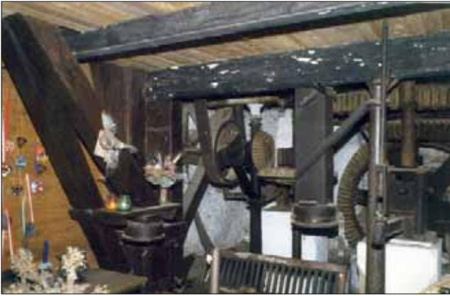
Bild 7: Antriebskeller: mittig: Antrieb für Transmission auf dem Sichterboden (NiG8); links Elevatorfuss für Mahlgut des Weizenganges zum Rundsichter; vorne: Absatzstützen für Schrotgangauslauf des Mahlgutes.
