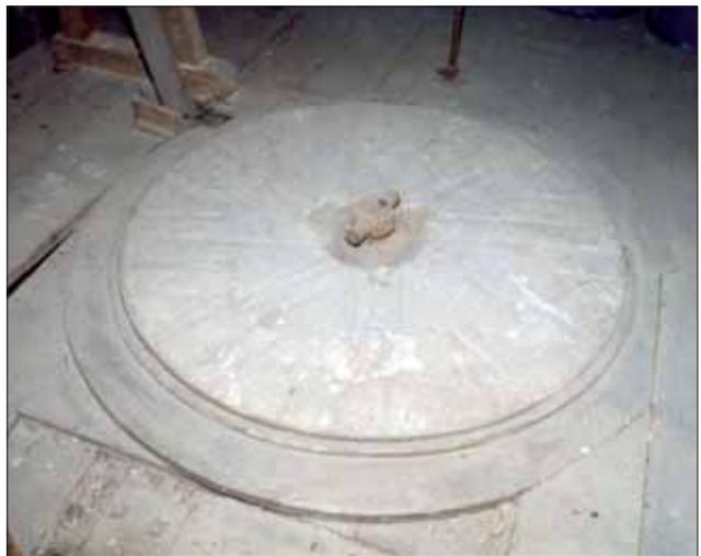
Bild 13: Steinboden: (NiG1) Weizengang: Bodenstein, Durchmesser 140 cm, ein Süßwasser-Quarz, auch 'Franzose' genannt.
