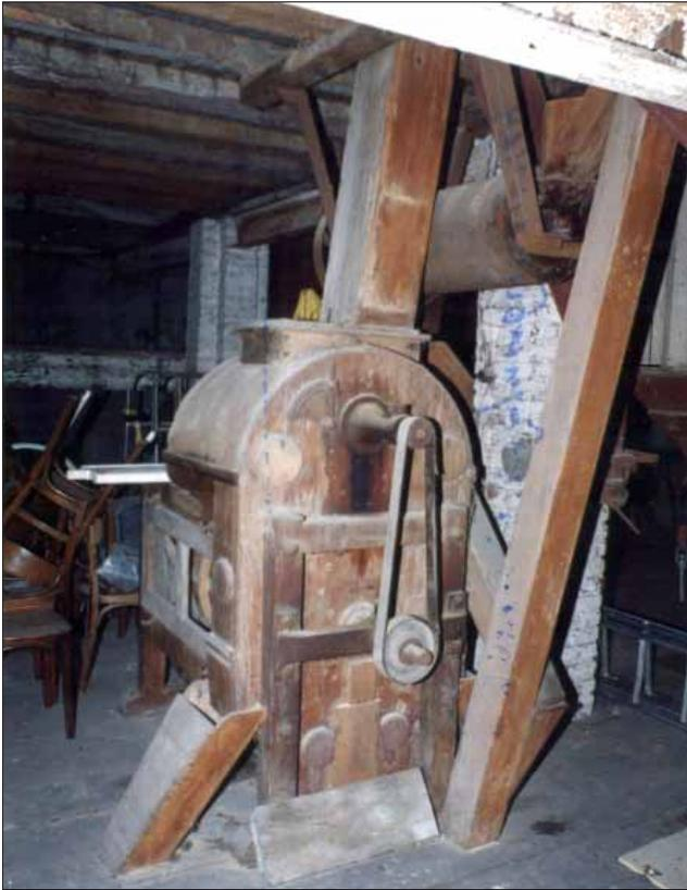
Bild 17: Steinboden: (NiG4) Trieur (obere Bildhälfte); (NiG5) Putz- und Schälmaschine.
