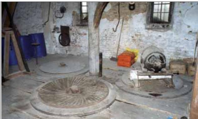
Bild 14: Steinboden mit Bodensteinen: Durchmesser 140 cm von links: 1) Weizengang 2) Roggengang (Basalt) und 3) alter E-Motor ohne Funktion.
