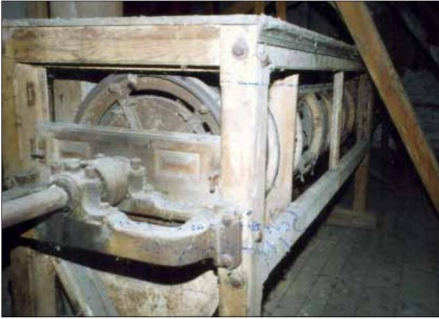
Bild 16: Sichterboden: großer Rundsichter (NiG3), dem Weizengang nachgeschaltet.
