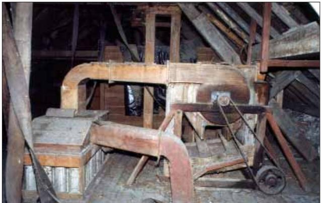
Bild 15: Sichterboden: Linke Bildhälfte: Filteranlage (NiG2). Rechte Bildhälfte: Getreidereinigung (NiG1).
