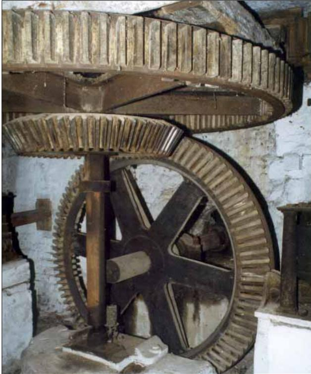
Bild 3: Antriebskeller: Kraftübertragung vom Wasserrad zum Königsrad.
