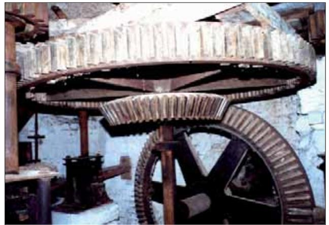
Bild 2: Antriebskeller: Wasserradwelle mit großem Tellerrad (NiG5), gusseisern mit Buchenkämmen. Auf der Königswelle oben Königsrad (NiG6), gusseisern mit Buchenkämmen, darunter gusseisernes Kegelrad zur Kraftaufnahme vom Wasserrad.
