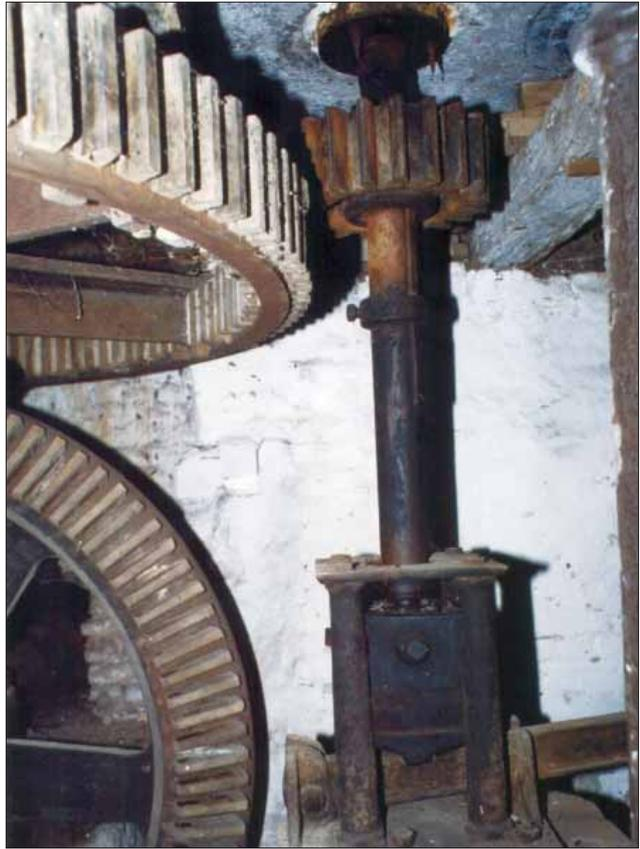
Bild 10: Antriebskeller: Mühleisen des Roggenganges; oben ausgerichtetes, gusseisernes Ritzel; Antrieb vom Königsrad. Unten: Gusseisenblock mit Spurzapfenlager für den Antrieb des Roggenganges, Steinboden (NiG2).
