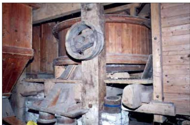
Bild 3: Steinboden: Schrotgang (NIG1) und Vorratsbehälter.
