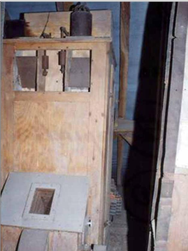
Bild 18: Plansichter-Boden: Aspiration (NiG10).
