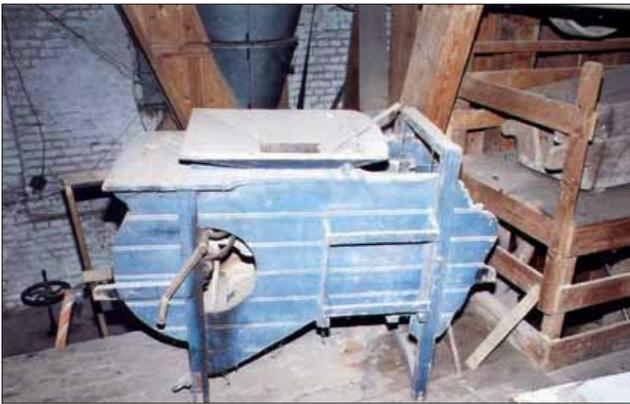
Bild 12: Handreinigungsmaschine (Wehmühle).
