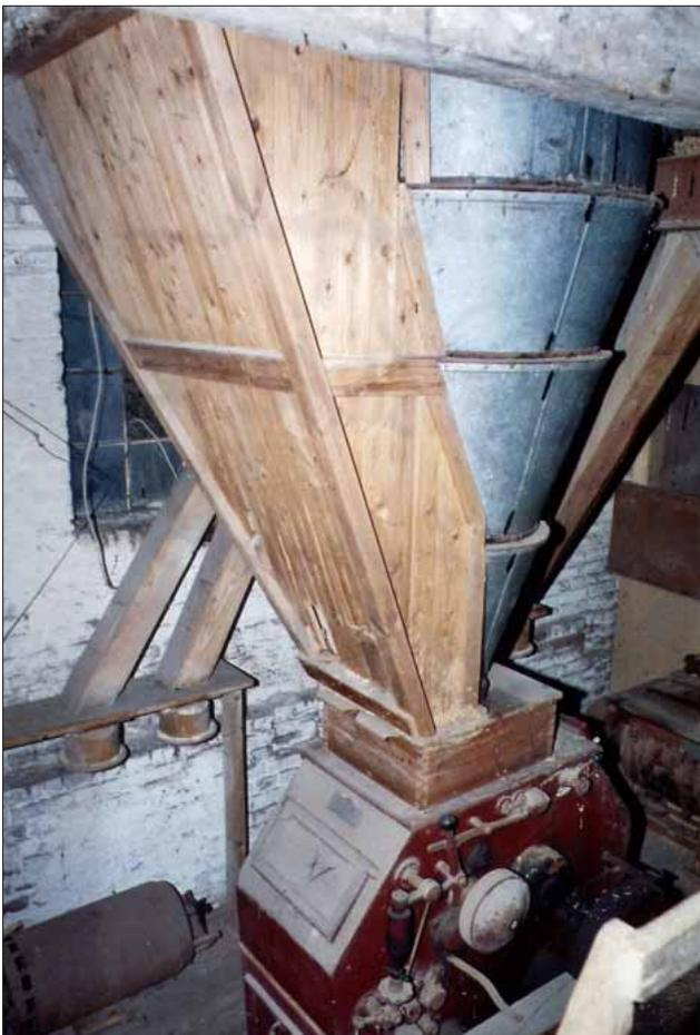
Bild 9: Schütt-Trichter Schrotgang (NiG1).
