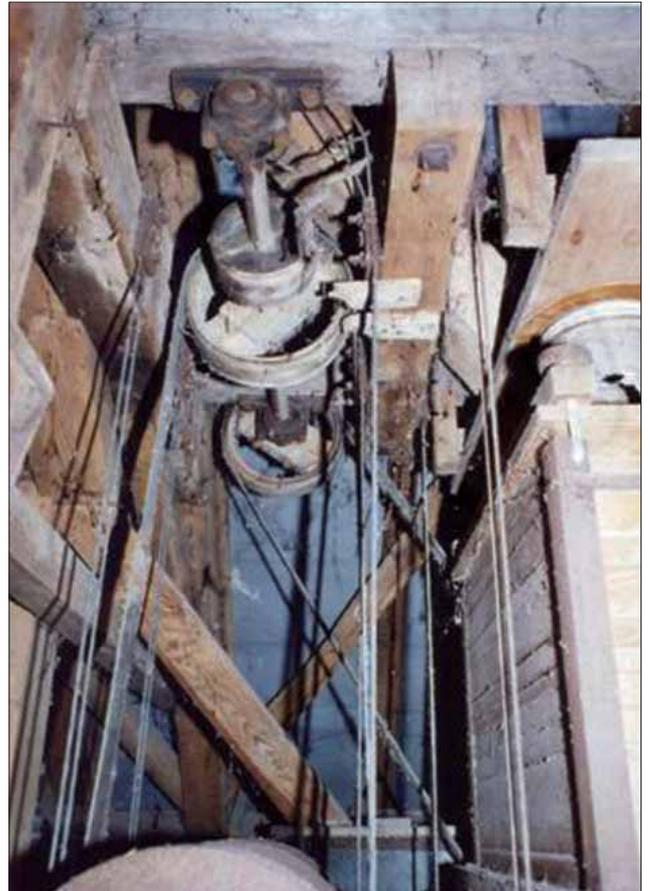
Bild 19: Plansichter-Boden: Plansichter-Antrieb (NiG9).
