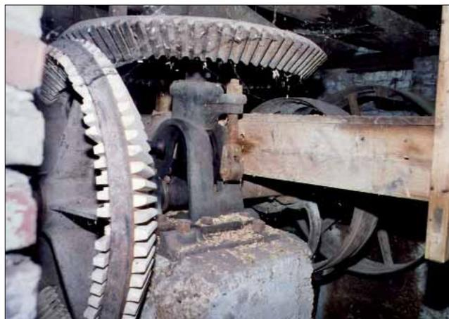
Bild 4: Kriechkeller: Winkelgetriebe für Schrotgang (NIG1).
