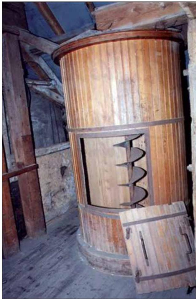
Bilder 22/23: Steinboden (NiG6): Mischmaschine mit Schnecke.
