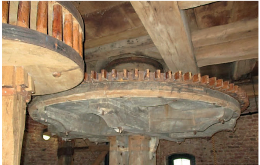
Stirnrad SKw auf der Königswelle zum Antrieb der ehemals 3 Windmahlgänge und der stehenden Welle W3.
