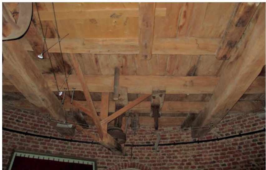
Fußlager der stehenden Vorgelegewelle W2 mit Kegelrad zum Antrieb von drei Transmissionswellen T, deren Lagerhalterungen an der Decke zu sehen sind.
