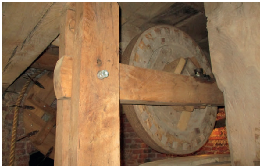
Das Laufrad auf der Aufzugswelle für Windbetrieb war ehemals als Kammrad ausgeführt.
