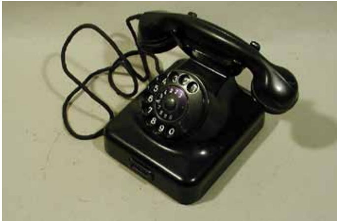
Objekt: Telefonapparat; Material: Kunststoff, Kupfer, Eisen, Gummi.
