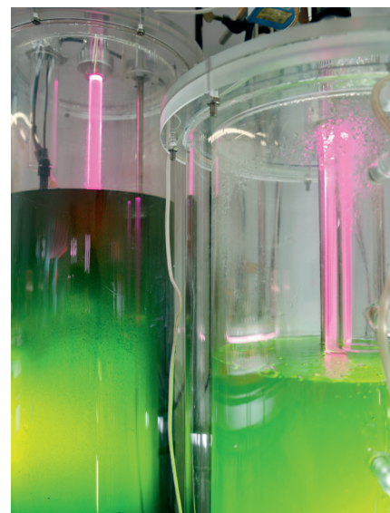
Plexiglasreaktor zur Kultivierung von Algen unter Verwendung von LED-Beleuchtungen mit speziell abgestimmten Wellenlängen
