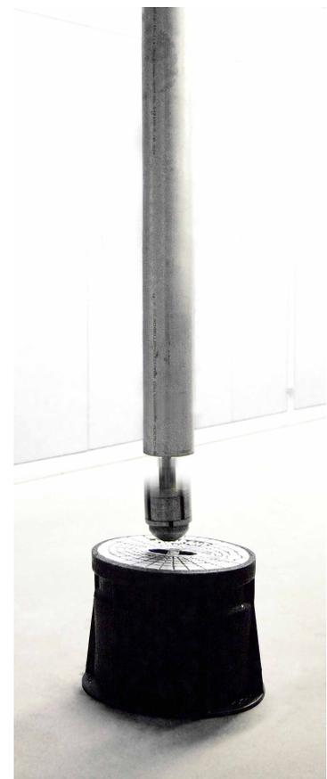
Abbildung 2: Fallversuch an Straßenkappen (Quelle: GWI, 2017)
