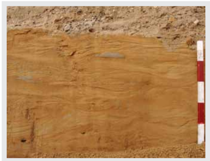
Abb. 10: Schräglaminierte Schluffe, Aufschluss senkrecht zur Strömung
