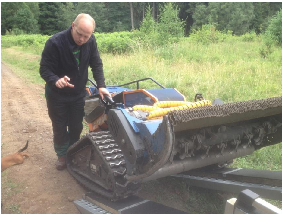
Abb. 41: Andre Schubert vom Stadtdienst Natur und Umwelt der Stadt Solingen führt einen ferngesteuerten Schlegelmulcher der Firma IRUS vor (Foto vom 28.6.2017, BSMW, Boomers).
