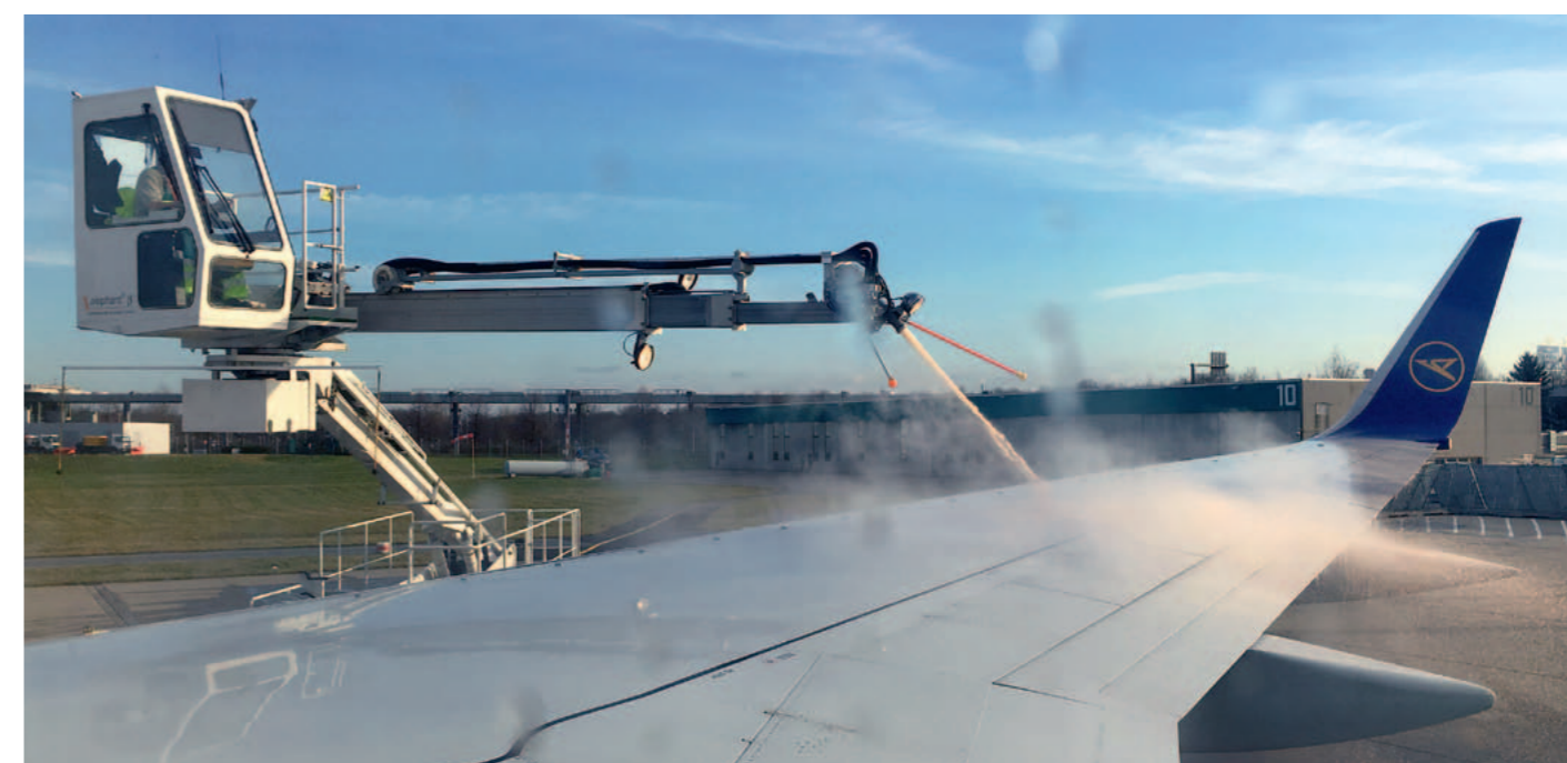
Flugzeug-Enteisung auf dem Vorfeld. Während der Wintermonate wird das dabei anfallende Abwasser über Stauraumkanäle in Regenklärbecken umgeleitet und dort auf eine Belastung mit organischem Kohlenstoff untersucht.
