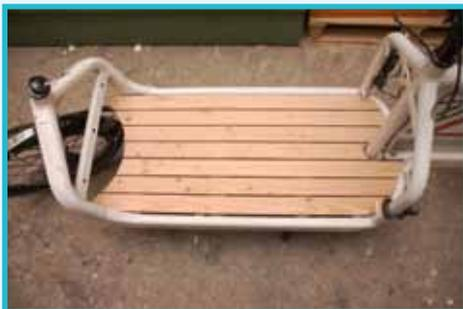
Nun zeigt sich auch, an welchen Stellen gegebenenfalls noch ein wenig nachzuschneiden oder zu schleifen ist, so dass sich das Deck perfekt in den Rahmen des Bullitts einfügt. Sobald die Bearbeitung des Decks fertig ist, sollte das Deck noch allflächig mit Leinöl geschützt werden.
