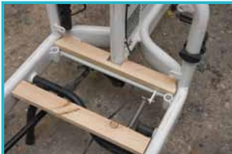
Auf jedem Querholm der Ladefläche liegt eine Strebe, durch die, bevorzugt mit nicht rostenden Edelstahlschrauben, die Beplankung geschraubt wird.
