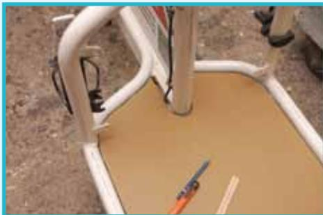
Diese sollte zur Vereinfachung aus zwei Teilen bestehen, die später zusammengesetzt werden. Beim Erstellen dieser Schablone fiel übrigens auf, dass am Bullitt die rechte und die linke Seite nicht identisch sind, da sind schon ein paar Millimeter Unterschied im geschweißten Alurahmen.
