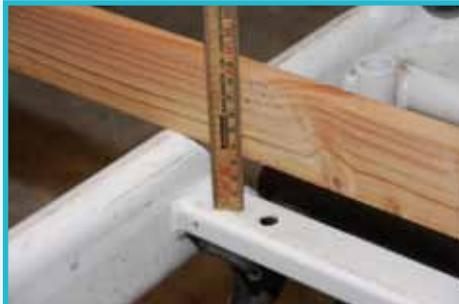
Hier sind es 36mm, die in 16mm Unterkonstruktion und 20mm Decklattung aufgeteilt werden. Dank der Schablone stehen auch Breite und Länge des Decks fest. Für das Schreiner-Bullitt wurde Douglasie gewählt, ein relativ beständiges, haltbares, aber weiches Konstruktionsholz, welches auch gerne für den Terrassenbau eingesetzt wird. Aber auch andere Holzarten sind prima geeignet, wie Kiefer, Esche, Eiche, die sogar alle besonders astrein sind.
