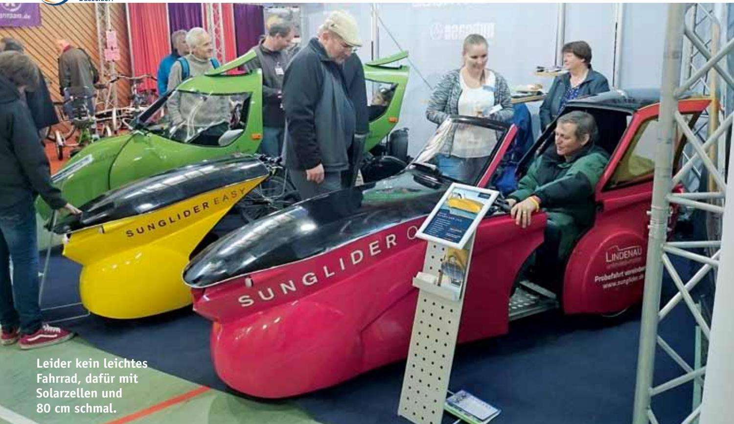
Leider kein leichtes Fahrrad, dafür mit Solarzellen und 80 cm schmal.
