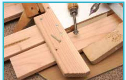
Nach dem vollständigen Verschrauben nun Klemmen ab, Hilfsplatten entfernen, das Deck umdrehen und die Schablone auflegen. Konturen nachzeichnen und mit einem frischen Blatt in der Stichsäge der Kontur nach aussägen.
