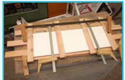
Nach der Kontrolle mit einem Winkel wird die gesamte Konstruktion verspannt und vorgebohrt. Nun sollte jedes Bohrloch gesenkt und mit passenden Schrauben - 3,5\*30mm - verschraubt werden.
