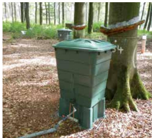
Stammabflussanlage an einer Buche
