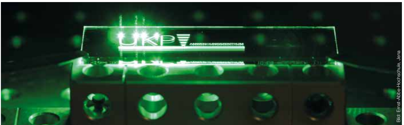
Strahlbasiertes Abtragen – hier kommt der UltrakurzpulsLasers zum Einsatz.
