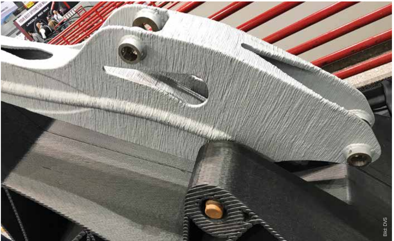
Gelenkausleger eines Baggers, gefertigt mittels WAAM-Verfahren. (Prototyp, ausgestellt auf der FABTECH, 6. bis 9. November 2017, Chicago/USA).
