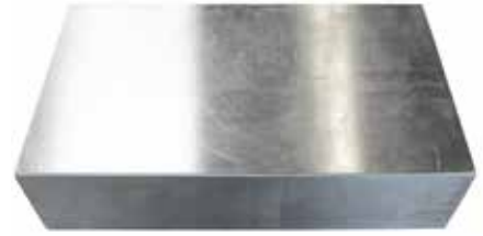
Rohmaterial bei der konventionellen Fertigung Gewicht: 85 kg
