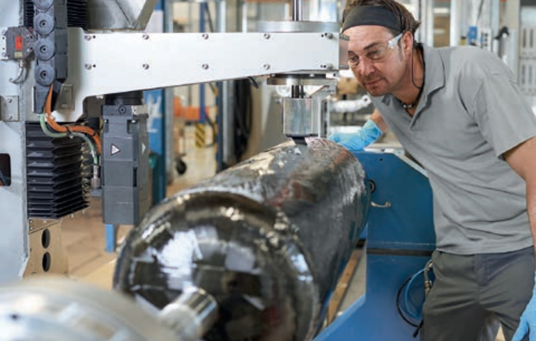
Produktion eines CFK-Behälters (H 2 -Speichers) bei NPROXX, Jülich
