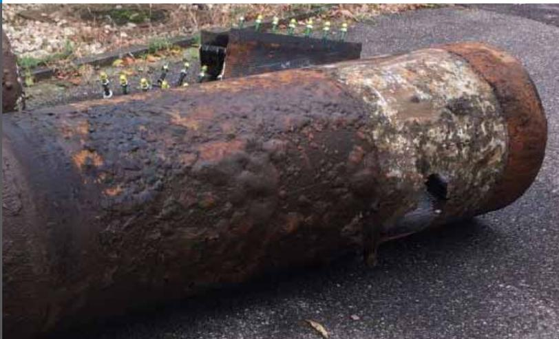
Kläranlage Dülken: Korrodierte Leitung
