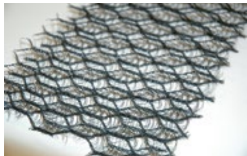
Ideale Wabenstruktur für die Aufnahme von Wasser aus der Luft
