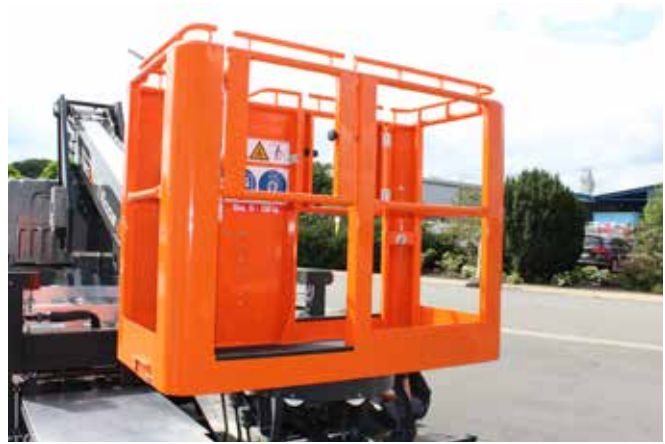
Bild 56: Hubarbeitsbühne mit Bodenplatte aus AFS®, Klaas Alu-Kranbau
