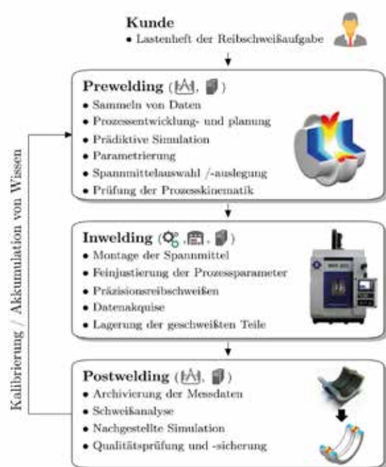
Bild 28: Beispiel Arbeitszyklus Smart Rotary Friction Welding (SRFW) für die Bewältigung einer Reibschweißaufgabe nach Industrie 4.0-Prinzipien
