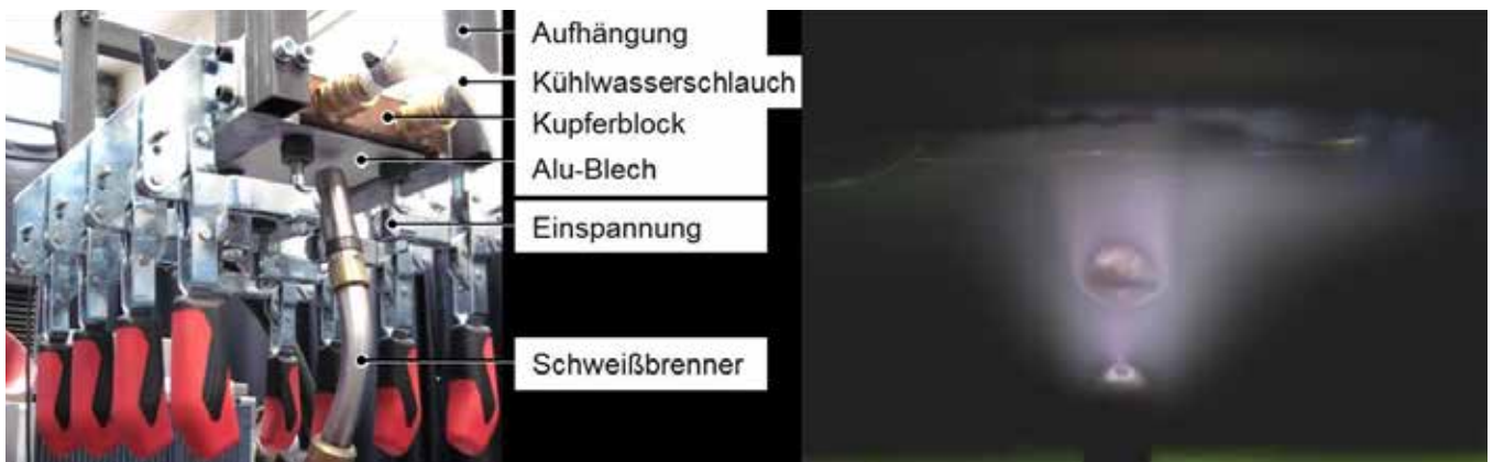
Bild 39: links: Schweißversuchstand zum Auftragschweißen in Überkopposition mit aktiver Kühlung zum Einfrieren aufsteigender Wasserstoffporen; rechts: Grober Tropfenübergang im Sprühlichtbogen
