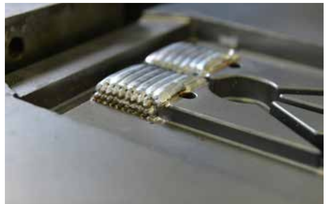
Bild 38: Anwendung des Elektronenstrahlauftragschweißens an einem Formeinsatz (links) mit aufgeschweißtem Bereich (rechts)
