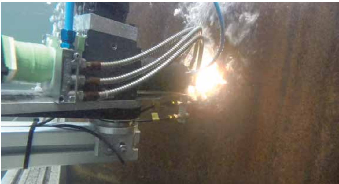
Bild 69: Unterwasserschneidprozess im Einsatz am entwickelten Achssystem im Unterwassertechnikum Hannover des Instituts für Werkstoffkunde in Zusammenarbeit mit dem Laser Zentrum Hannover e. V., der LASER on demand GmbH und der Tauchmayer GmbH
