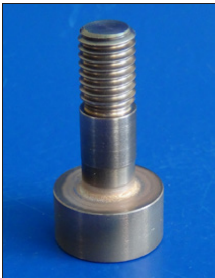
Bild 56: Flussmittelfrei gelöteter Prüfkörper aus 1.4301 für die Zugprüfung
