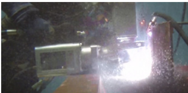
Bild 78: Manuelle Erprobung des CAMG-Handgerätes
