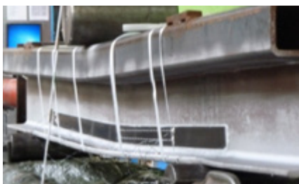
Bild 61: Verstärktes Hohlprofil im Vier-Punkt-Biegeversuch (oben) und Bauteilversuch eines Kranbahnträgers (unten)
