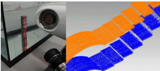
Bild 69: Messung eines Prüfkörpers, welcher sich im Wasser befindet. Die Navigation erfolgt an der Luft. Links: Versuchsaufbau Rechts: Ergebnispunktwolke Oben: Auswertung ohne Brechungskorrektur Unten: Auswertung mit Brechungskorrektur
