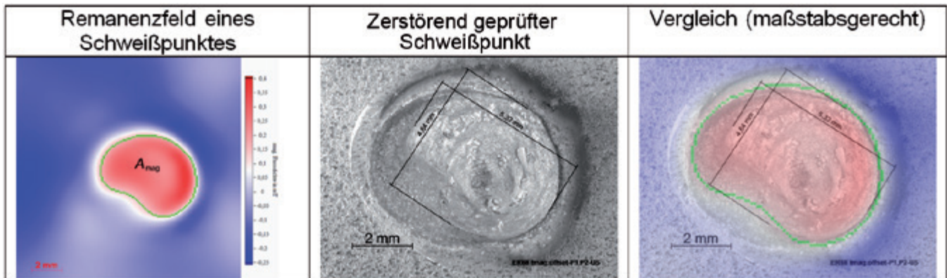
Bild 42: Vergleich zwischen zerstörungsfreier Remanenzmessung und zerstörend geprüfem Schweißpunkt
