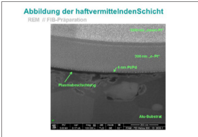
Bild 51: Rasterelektronenmikroskopische Abbildung der im Plasma abgeschiedenen haftvermittelnden Schicht auf Aluminium nach einer FIB-Präparation. Die Beschichtung überdeckt die Defekte der Aluminiumoberfläche
