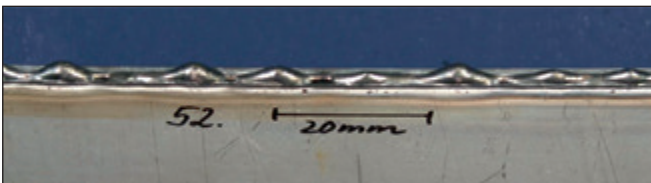
Bild 64: Humpingbildung bei NV-EB-geschweißter Bördelnaht (Werkstoff DC04, Blechdicke 0,8 mm, Schweißgeschwindigkeit 10 m/min)
