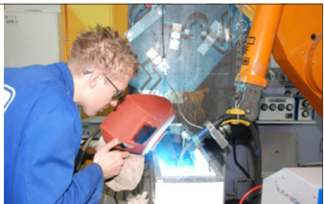
Bild 40: Messsystem zur Bestimmung des Energieflusses verschiedener Schutzgasschweißverfahren
