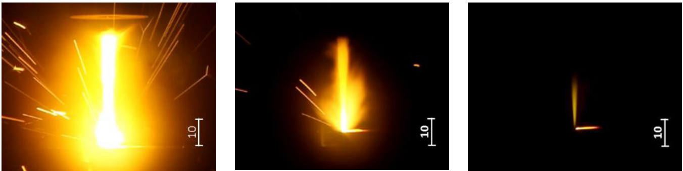
Bild 45: Darstellung der Metalldampffackel und Spritzerbildung bei 1000 mbar (links), 100 mbar (mitte) und 10 mbar (rechts).
