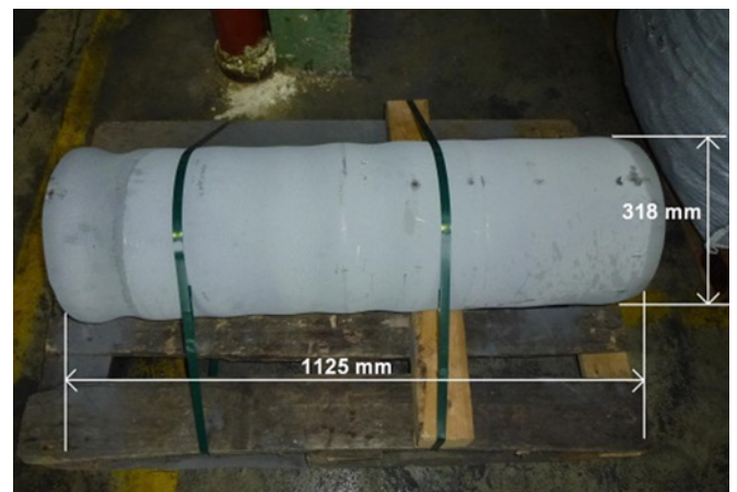
Bild 48: Sprühkompaktierter Bolzen der Legierung AlSi10Cu8Sn2Mg1 im industriellen Maßstab
