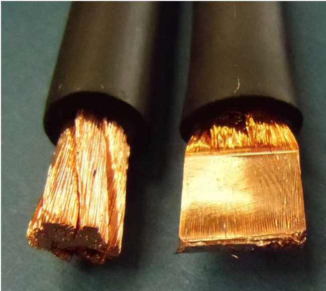
Bild 39: Abisolierte und kompaktierte 25 mm 2 Kupferlitze (li.) und Parameterfeld (re.)
