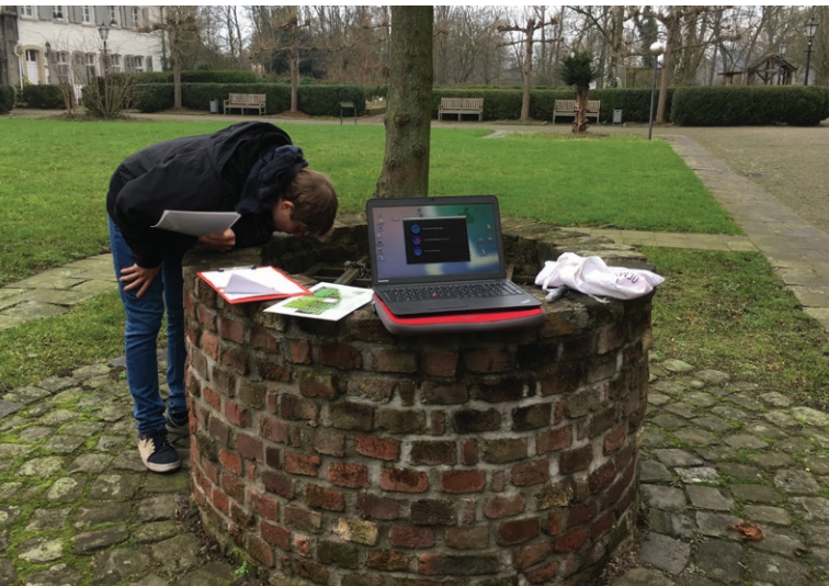
Abbildung 119: Auslesen des Dataloggers aus dem Brunnenschacht im Kloster Saarn
