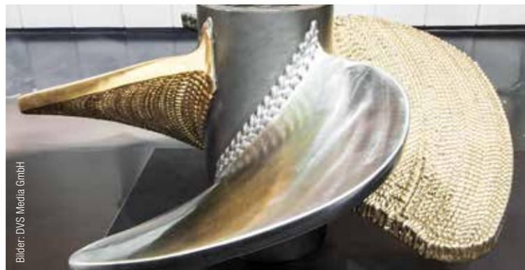
Eine mit Lichtbogen additiv gefertigte Schiffsschraube. Die verschiedenen Blätter zeigen unterschiedliche Stadien des Herstellungsprozesses.
