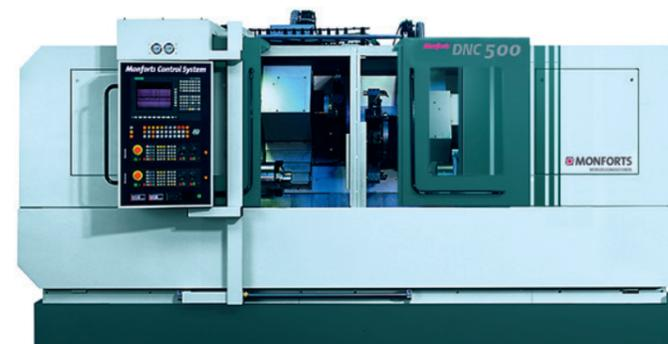
Zwei in eins mit DNC 500: Die Ausstattung mit zwei Werkzeugaufnahmen und zwei Spindeln ermöglicht die beidseitige komplette Bearbeitung von Bauteilen
