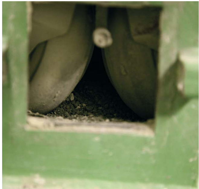
Bild 3.1.1-2 Mahlraum der kleintechnischen Vertikal-Wälzmühle
