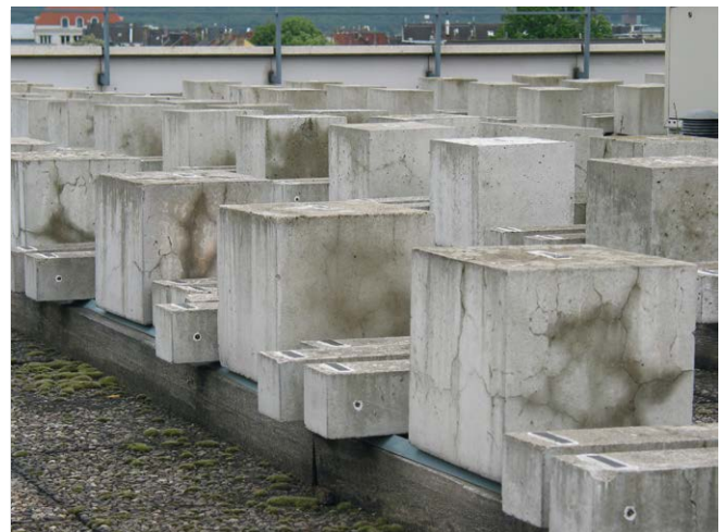
Bild 3.4.13.3-1 Betonwürfel und -prismen im Außenlager des VDZ zur Herstellung der rezyklierten Gesteinskörnung
