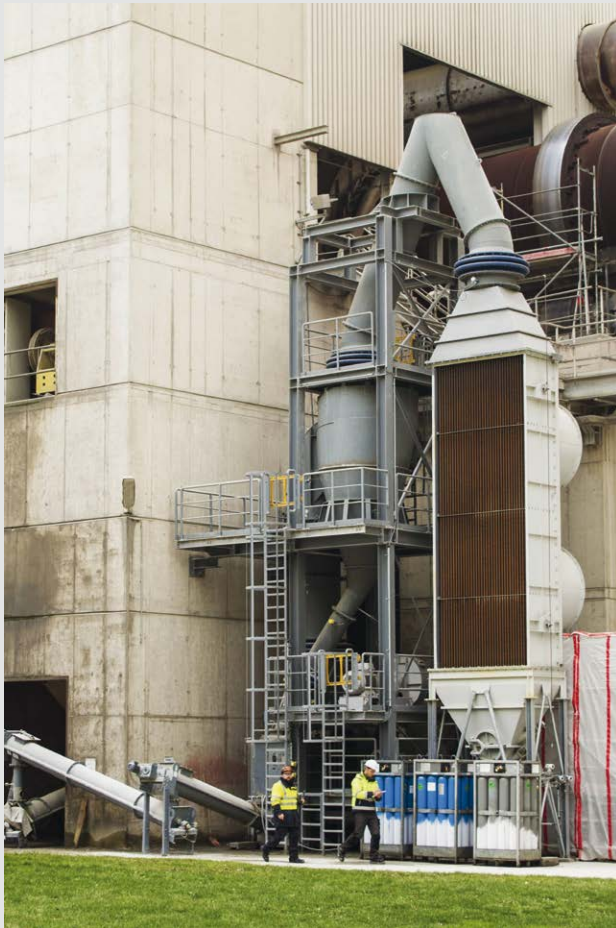
Bild 1.3.1-1 Der Prototyp des Oxyfuel-Klinkerkühlers im Praxistest
