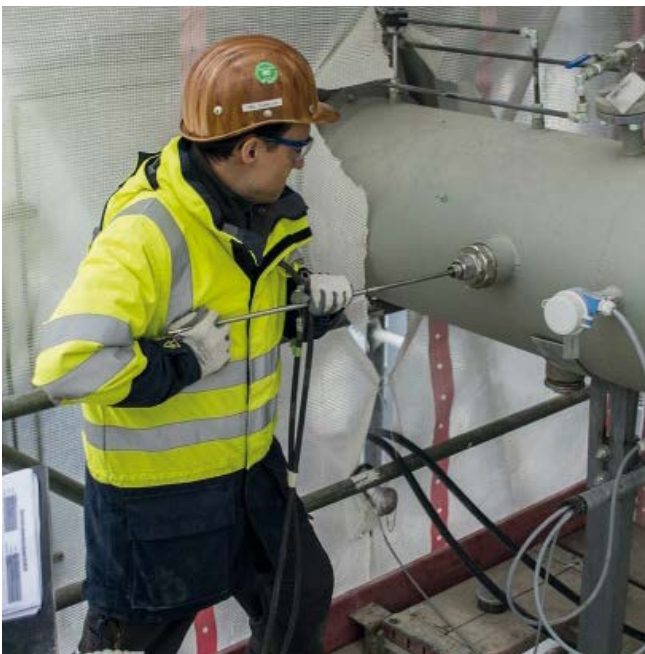
Bild 3.2.4-3 Messungen des VDZ bei der Erprobung des Prototypen eines Oxyfuel-Klinkerkühlers im Zementwerk im CEMCAP-Forschungsprojekt 3)
