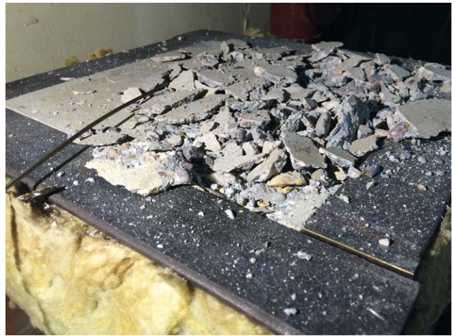
Bild 3.4.6-2 Oberfläche eines Probekörpers nach dem Abplatzen
