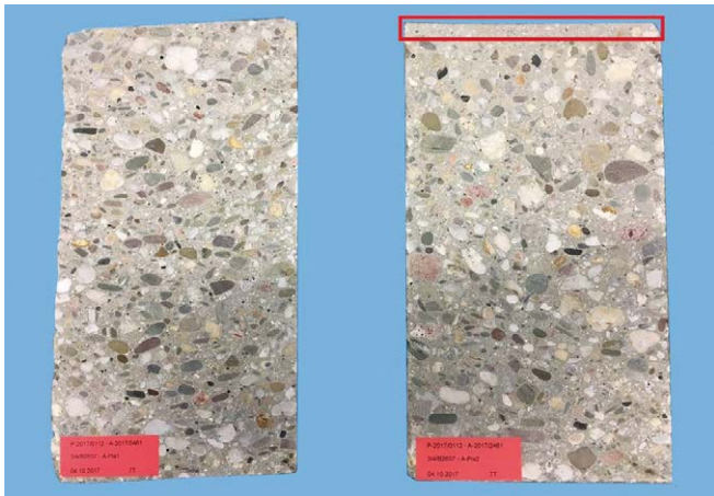
Bild 3.4.15-1 Gefüge eines mittelviskosen LVB nach Verdichtung mittels Rakeln (links) bzw. nach Verdichtung auf dem Rütteltisch ( f = 50 Hz) für jeweils 20 Sekunden in drei Lagen (rechts); markierter Bereich: Sichtbare Sedimentation der groben Gesteinskörnung
