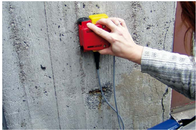
Bild 2.3-5 Lebensdauerbemessung an einem Betonbauwerk
