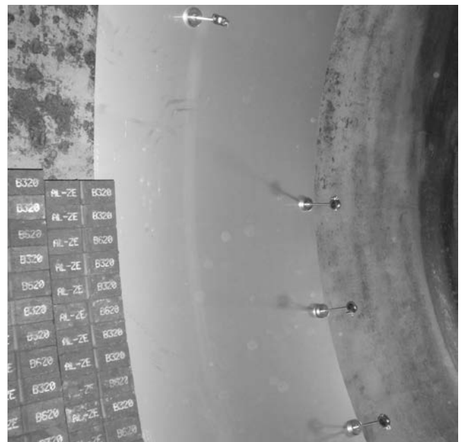
Bild 2.1.2-2 Opferschicht zum Schutz des Ofenmantels vor Korrosion
