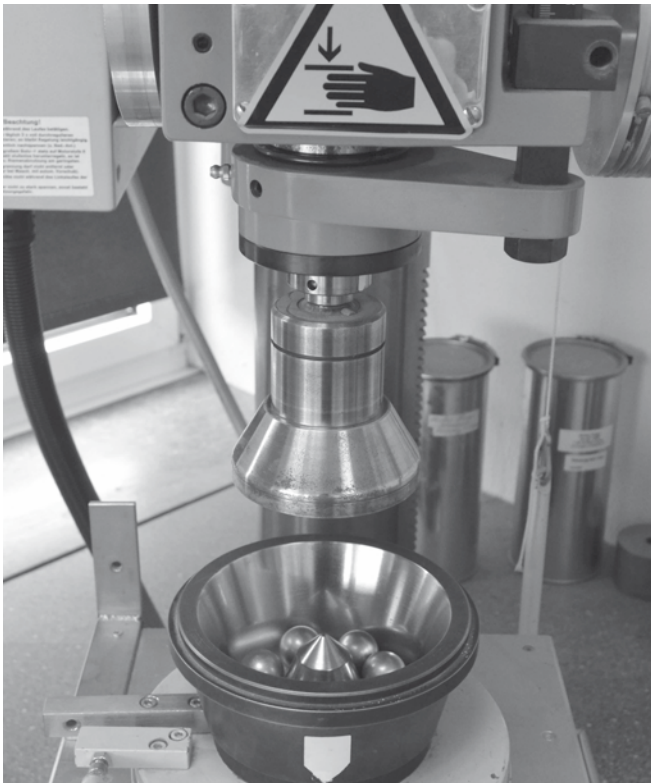
Bild 2.1.7-1 Mahlbarkeitsprüfer nach Zeisel Fig. 2.1.7-1 Grindability testing device acc. Zeisel
