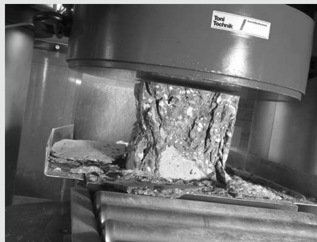
Test der Betondruckfestigkeit im VDZ-Betonlabor Test of compressive strength in VDZ's concrete laboratory
