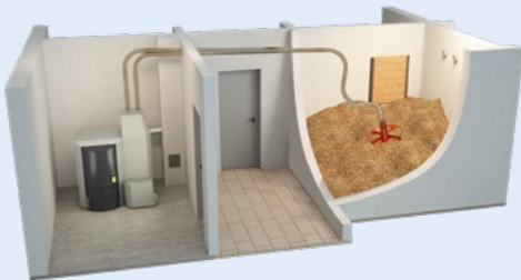
Pelletlagerraum, die Saugaustragung erfolgt über einen Maulwurf
