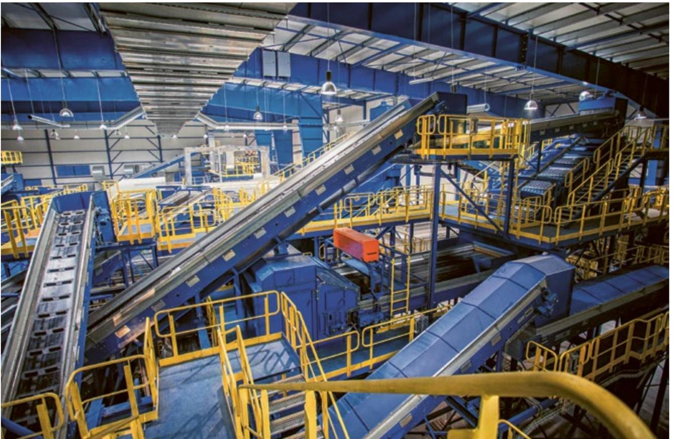
Die Sutco RecyclingTechnik GmbH (Bergisch-Gladbach) liefert modulare Hausmüll-Sortier- und Aufbereitungsanlagen, die Sortiertechniken wie Siebtrommeln, Magnettechnik, Ballistikseparatoren oder Nah-Infrarottechnik miteinander kombinieren.
