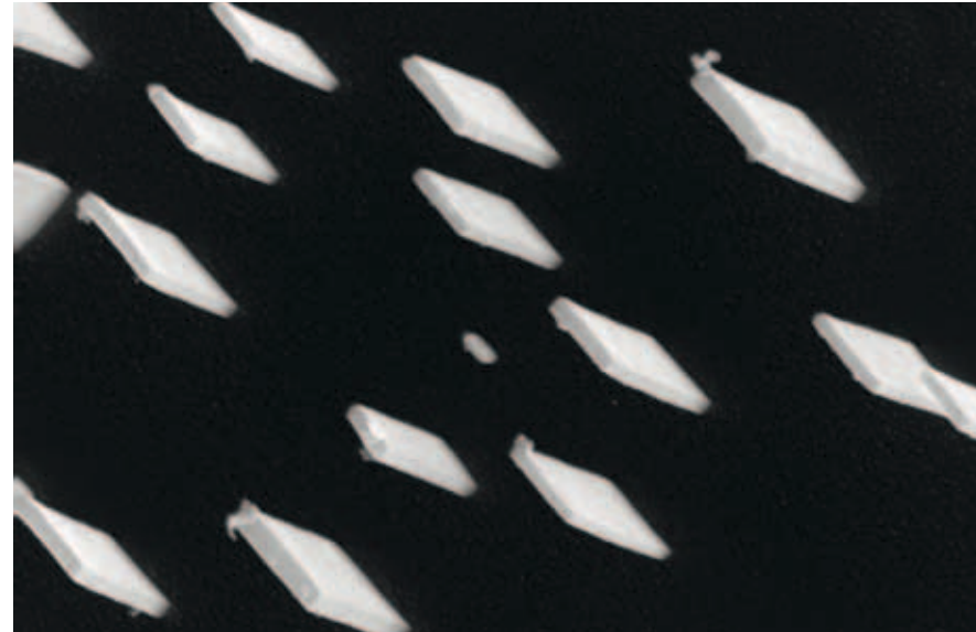
Nanobänder aus Gold, die bei einem Phasenübergang aus einer Eisen-Gold Legierung hervorgegangen sind.
