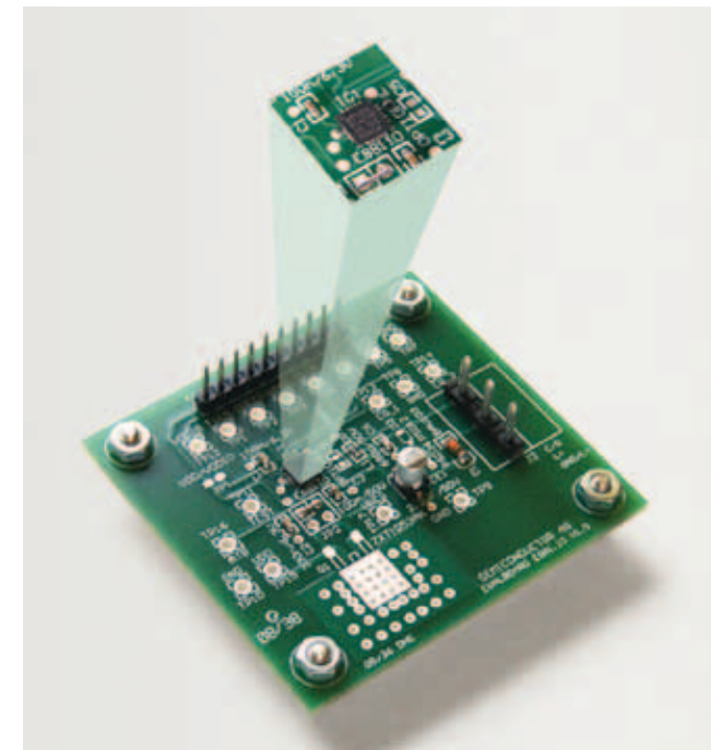
Der ELMOS-Chip E981.10 steuert und regelt den Datenfluss im neuen Industriennetzwerk IO-Link.
