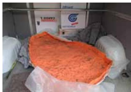
6. So sieht die fertige Negativform aus. Innen liegt die Silikonhaut, außen der Stützmantel aus Gips.
