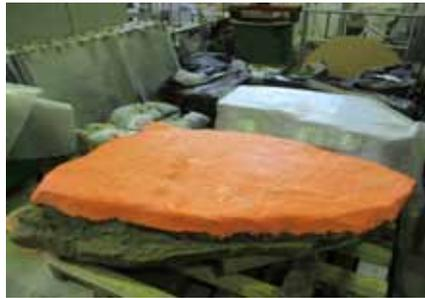
2. Für den Abguss muss zunächst eine Negativform hergestellt werden. Dazu wird eine Silikonhaut auf das Original aufgetragen.
