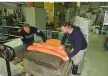
5. Nach dem Trocknen werden Stützmantel und Silikonhaut vom Original entfernt.
