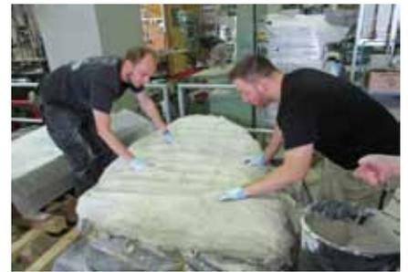
4a bis 4c Bau des Stützmantels. Er besteht aus Gips und einem lockeren Gewebe, dem so genannten Rupfen.
