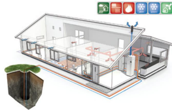
Wärmepumpen entziehen der Umgebung (Boden, Luft oder Wasser) Wärme, die dann zum Heizen und zur Warmwasserbereitung genutzt wird. Dabei wird das bis zu Fünffache der eingesetzten elektrischen Antriebsleistung wieder als Wärme erzeugt. Illustration: NIBE
