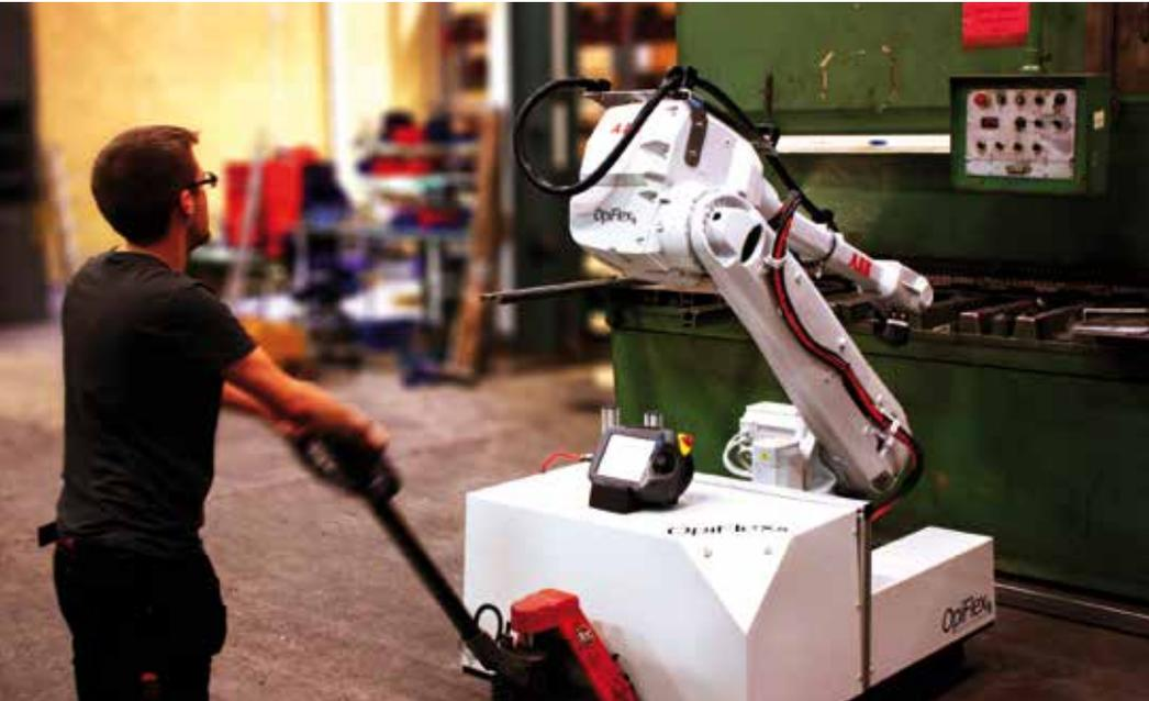
*Mit dieser mobilen Roboterplattform gewann OpiFlex aus Västerås den Business Innovation Observatory Award der EU-Kommission als „durchschlagendste Innovation“. Der Roboter kann mehrere Maschinen bzw Stationen flexibel bedienen und so insbesondere Kleinserienproduktionen deutlich effizienter machen.*
