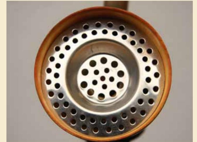
Abb. 10: Sensorium mit Reduktionsfilter
