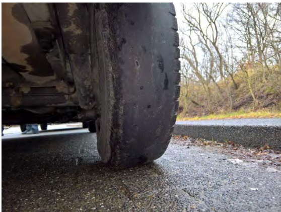
Foto: KPB Mettmann, Direktion Verkehr hier: nicht ausreichende Profiltiefe
