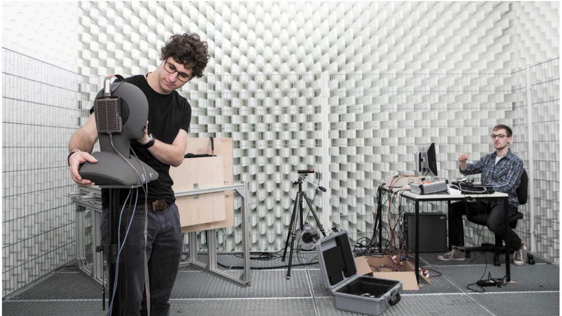
KÖPFHÖRERTESTS IN EINEM REFLEKTIONSARMEN RAUM IM FACHBEREICH MEDIEN
