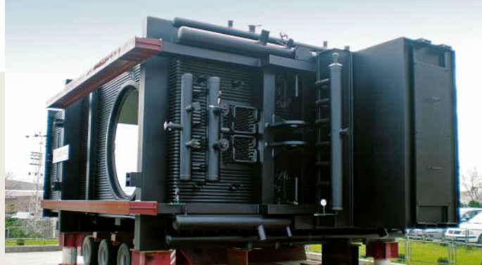
Wirtschaftlich und zukunftssicher: Das Heisskühlungsprinzip mit nachgeschalteter Wärmerückgewinnung (Bild unten). Fertig zum Einbau: Die Nachbrennkammer für eine Abgasstrecke nach einem Industrieofen.
