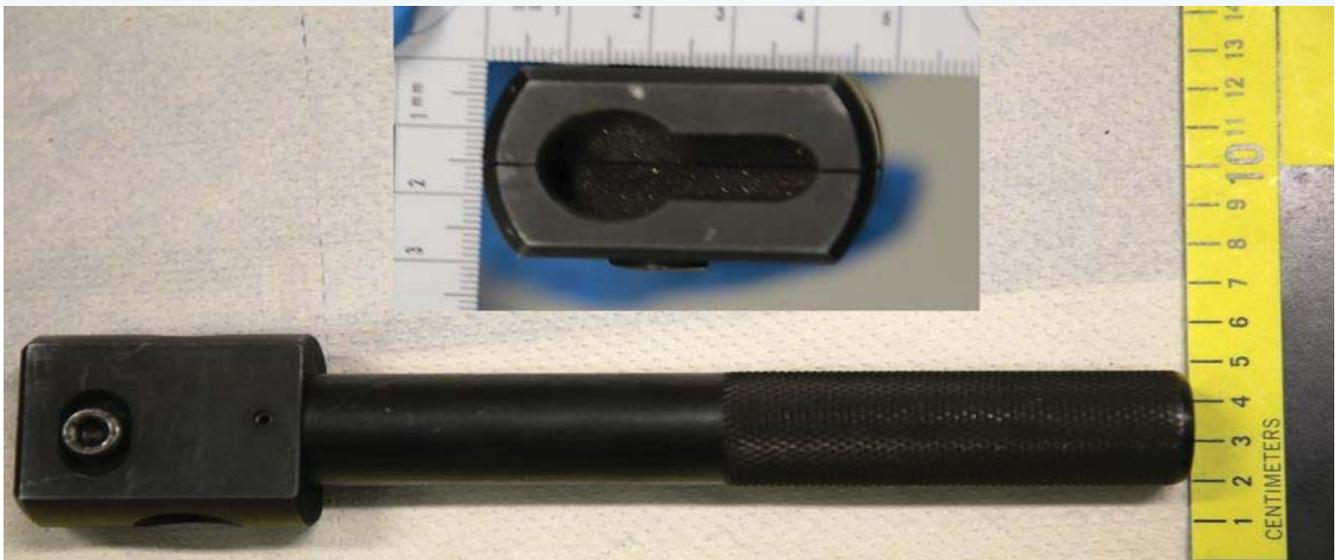
Dieses spezielle Einbruchswerkzeug zum gewaltsamen Herausbrechen von Zylinderschlössern wurde bei der Hausdurchsuchung bei dem Verdächtigen aufgefunden und sichergestellt.
