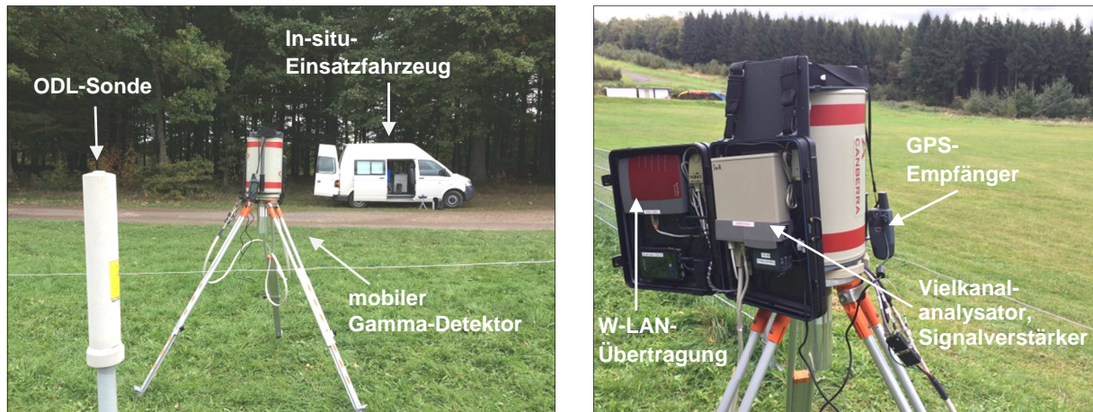
Abbildung 5.6: In-situ-Messung an einer ODL-Sonde.
