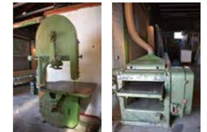
li.: Bandsäge re.: Dickenhobelmaschine
