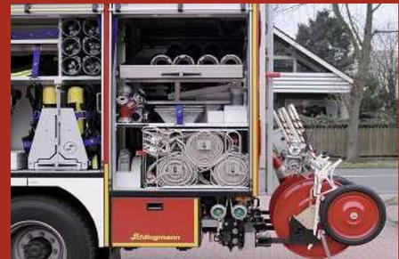
Mit 285 PS und 3000 Liter Wasser an Bord rückt die neunköpfige Besatzung aus. Während der Einsatzfahrt können zwei Trupps (4 Personen) ihre Atemschutzgeräte anlegen. Vor Ort ist der auf dem Dach montierte Wasserwerfer (1200 Liter/Minute, Reichweite 57 m) sofort einsetzbar.
