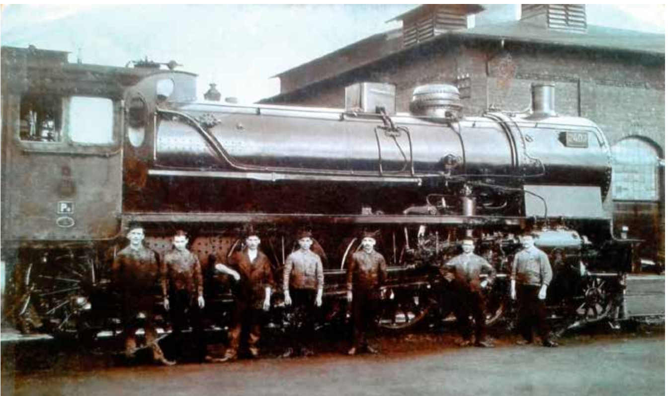
Walter Gräwinger, wahrscheinlich um 1908, mit den Eisenbahnern am Bahnhof Steinbeck vor einer P 8 Lokomotive der 1. Serie Nr. 2402 der Preußischen Staatseisenbahn. Die Lokomotive wurde von 1906-1930 in der Berliner Maschinenbau AG gebaut, hatte 1.180 PS und eine Höchstgeschwindigkeit von 100 Km/h. Sie wurde hauptsächlich als Personenzuglokomotive im Regionalverkehr eingesetzt und fuhr auf der Strecke Vohwinkel - Oberbarmen - Schee - Hattingen. Die letzten P 8 wurden bei der Deutschen Bundesbahn 1974, bei der Deutschen Reichsbahn schon 1972 ausgemustert. Mehr als 500 P 8 erreichten ein Dienstalter von über 50 Jahren.
