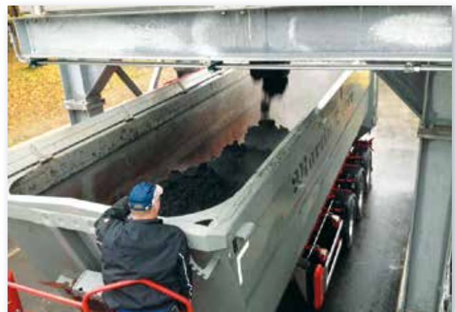
Silo Beladung LKW, Entsorgung entwässerter Faulschlamm
