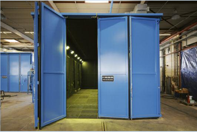
Einblick in eine Strahlhalle mit seitlicher Anlagentechnik bestehend aus Filteranlage und automatischer Strahlmittelrückförderung.
