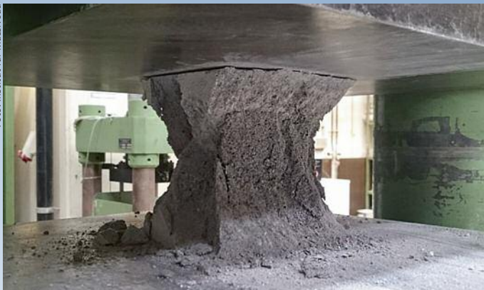
Im Labor des Instituts für Massivbau an der Universität Duisburg-Essen: Typisches Bruchbild der Aerogelbetonwürfel im Druckfestigkeitsversuch
