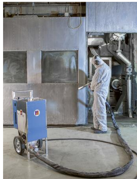
Reinigungsleistungen mit Trockeneispellets lösen selbst hartnäckigste Verschmutzungen von Maschinen und Anlagen.
