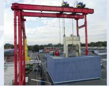
Bild links: Firmenumzug eines kompletten Werkzeugbaus mit 18 Bearbeitungszentren mittels hydraulischem Hubgerüst inklusiv Demontage, Transport, komplette Remontage, Feinjustierung. Bild rechts: Ausbringung einer 85t Presse über das Dach mit unserem Litzenhebersystem.
