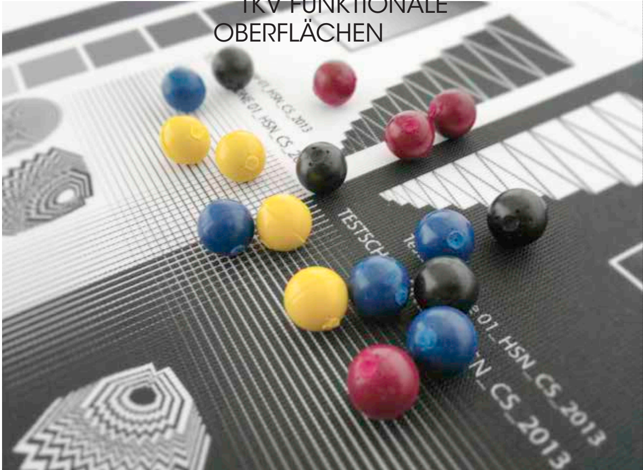
FARBIGE TONERPEARLS AUF BEDRUCKTEM TESTGEWEBE
