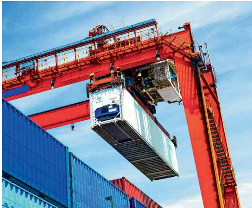
Leichter als sein Vorgänger: Container mit Boden aus verzinktem Feinblech SCALUR®+Z.
