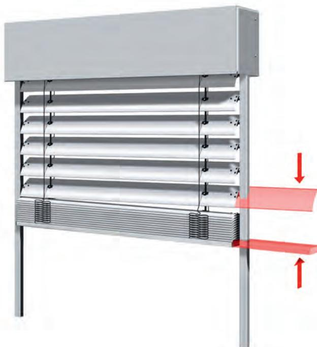
**Bild 7: Schräglauf der Unterschiene (bei parallelem Lamellenpaket)**
