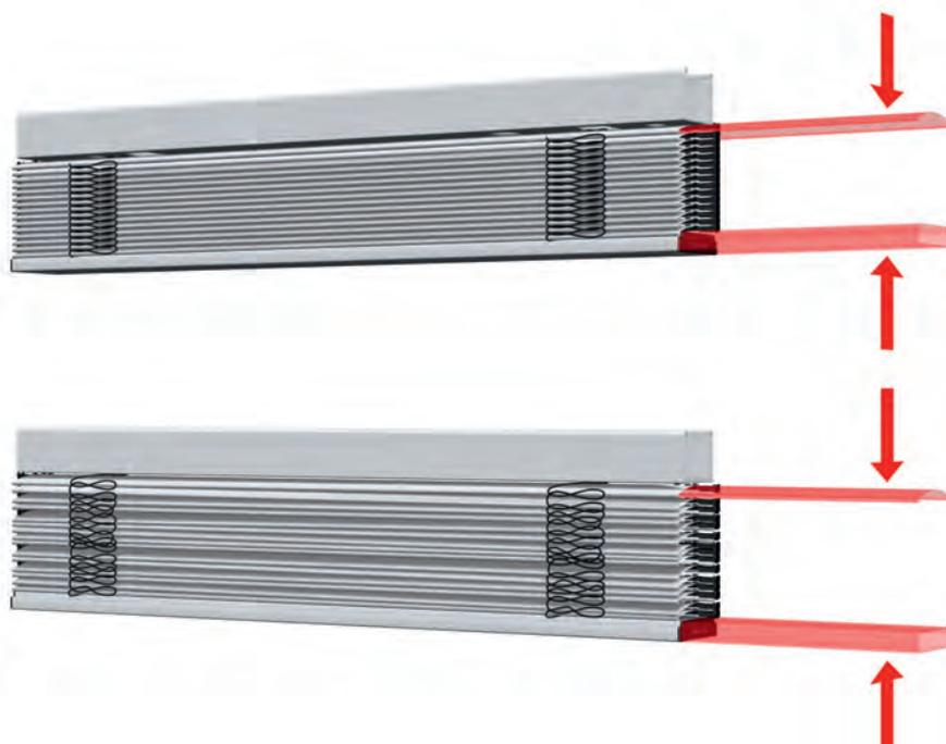
**Bild 8: Unterschiedliche Lamellenpakethöhen durch erhöhten Paketaufbau
