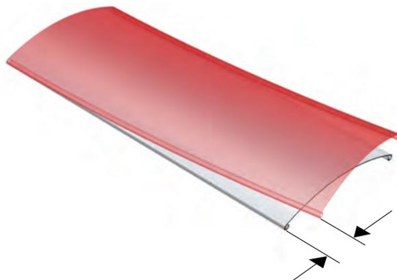
**Bild 14: Säbelförmigkeit**
