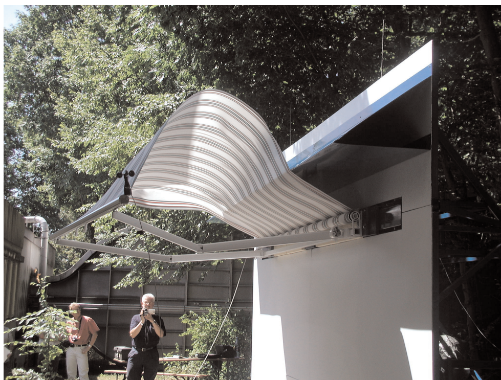
Bild 2: Beispielhaftes Verhalten einer Markise im Windkanal zur Energieabsorption
