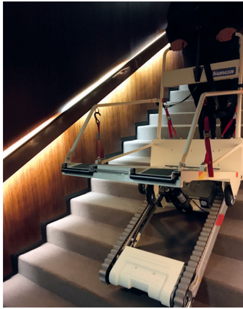
Eine Treppenraupe kann sinnvoll sein – muss jedoch immer von einer zweiten Person bedient werden.
